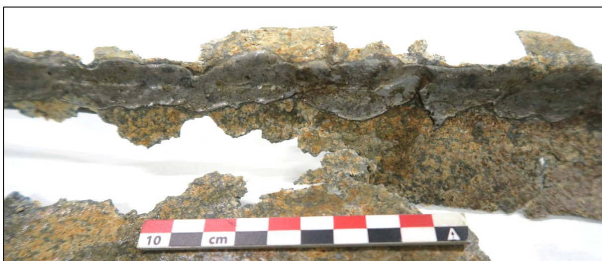
Figuur 14: Detail laswerk deksel.
