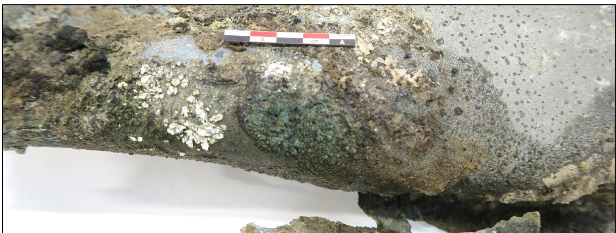
Figuur 20: Detail koperverkleuring binnenzijde zijwand.
